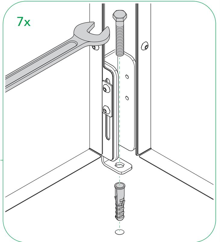
**DE** Die ideale Befestigung im Boden variiert je nach Untergrund. Das Befestigungsmaterial ist nicht im Lieferumfang enthalten.
